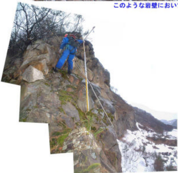
ポールやスタッフで不安定岩塊の規模を測定し、対策工の計画に必要なデータを収集します。
